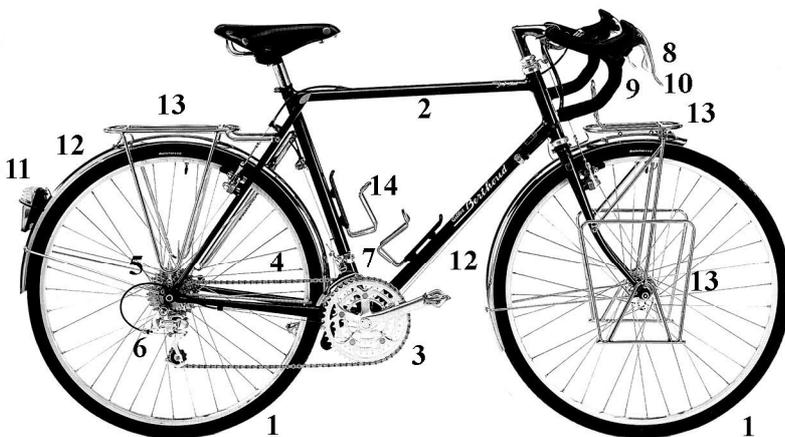
Figure 1.8. Les différents constituants d'une bicyclette. Ici, il s'agit d'une randonneuse réalisée par Gilles Berthoud.
